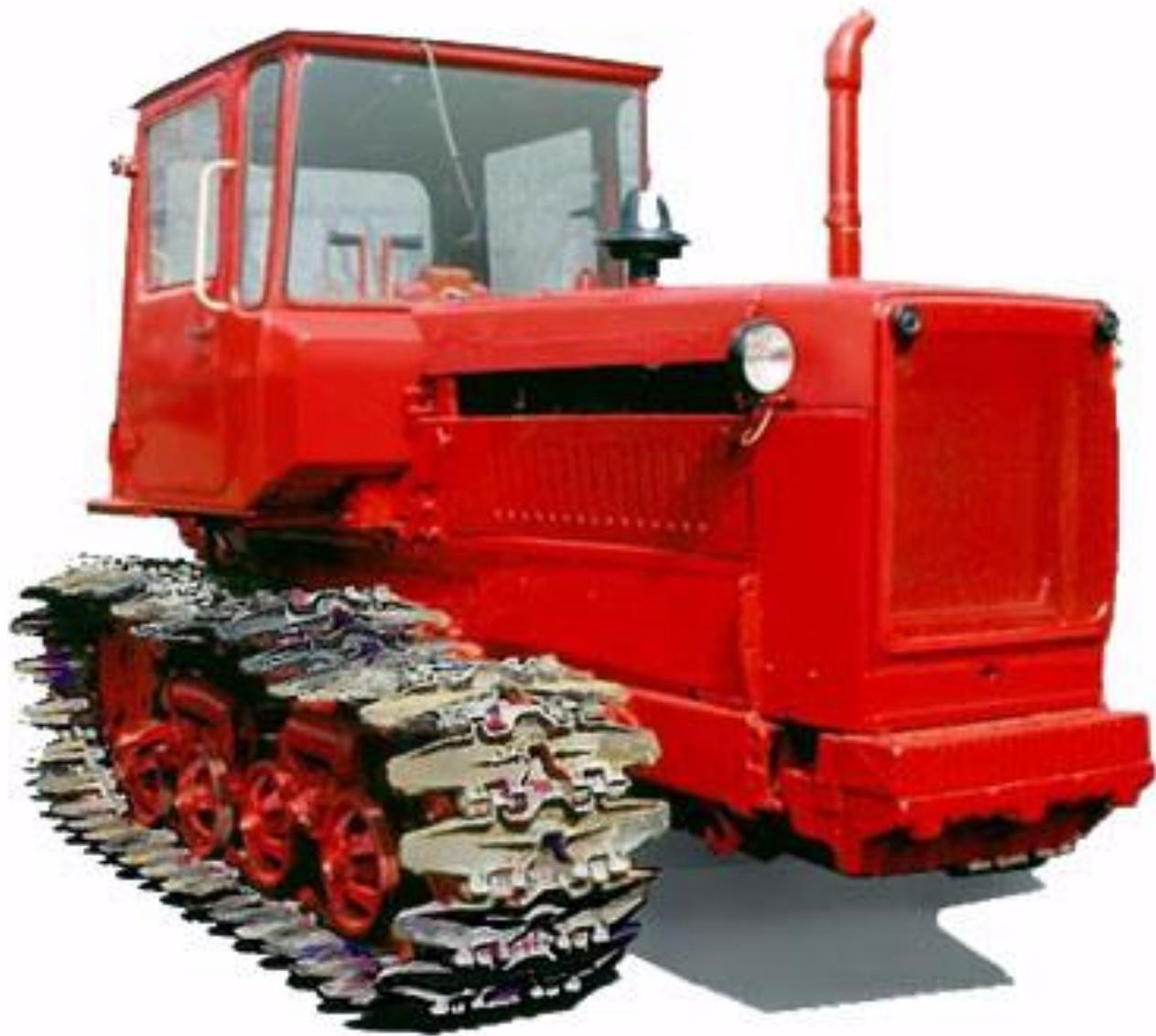
Гусеничный трактор ДТ-75М массой 6610кг производит давление на почву 47кПа вес, с которой он будет давить, равна
