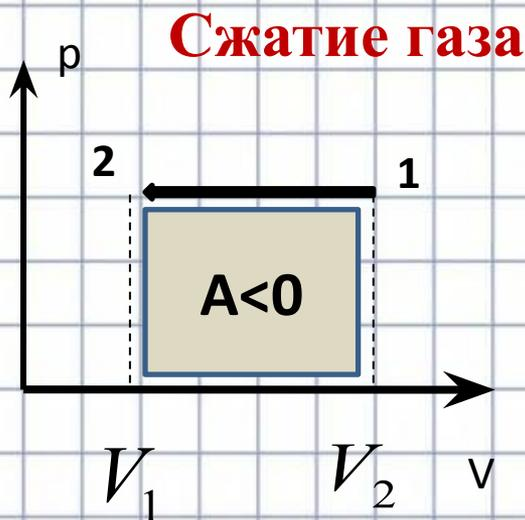
$$A_{\text{Газа}} = p \cdot (V_2 - V_1) = p\Delta V - \text{работа газа}$$
