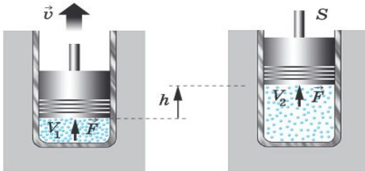
Работа в термодинамике – работа сил, приложенных к внешним телам со стороны системы при её деформации. Работа газа численно равна площади фигуры под графиком зависимости давления от объёма в координатах  $p, V$
