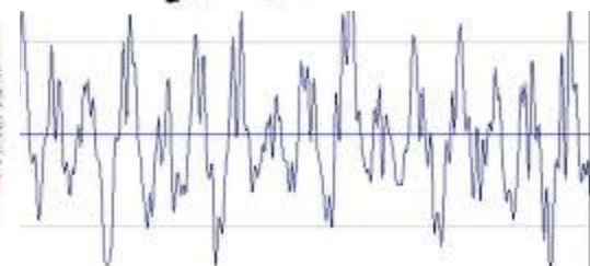
Рис. 23. Звуки нашего голоса, как и все окружающие нас звуки, представляют собой колебания воздуха или так называемые звуковые волны.
