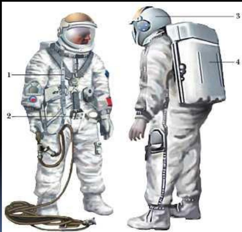
1 – страховочный фал; 2 – пульт управления системой жизнеобеспечения; 3 – гермошлем; 4 – ранцевая система жизнеобеспечения.
