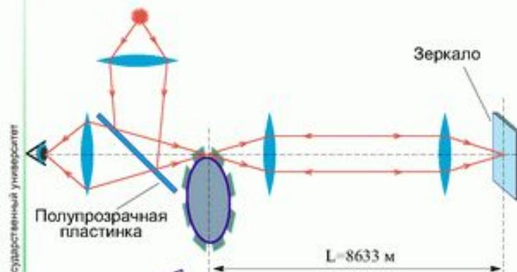
Зубчатое колесо с числом зубцов  $Z$
