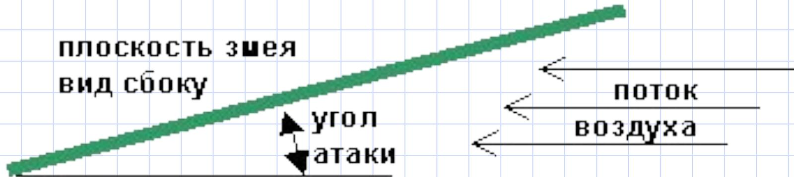
Для того, чтобы воздух мог поднять змея, он должен быть расположен под некоторым углом к потоку воздуха. Поток воздуха создает общее давление на змея с силой  $R$ , направленной перпендикулярно плоскости воздушного змея.
