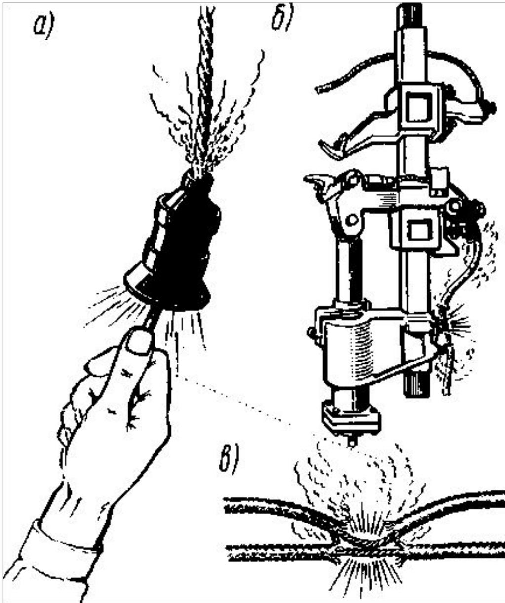
Короткое замыкание может возникнуть, например, при ремонте проводки под током или при случайном соприкосновении оголённых проводов.
