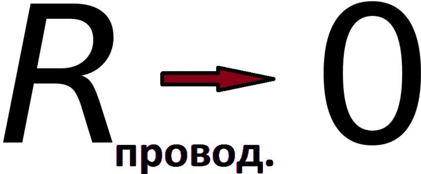
При коротком замыкании резко возрастает сила тока, протекающего в цепи, что приводит к значительному тепловыделению, и, как следствие, термическому повреждению устройства или электрических проводов, вплоть до возникновения пожара или электрической травмы.
