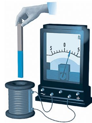
Возникновение тока при действии пост. магнита на катушку
