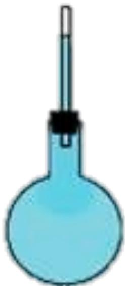
**Если нагревать воду, то за счет расширения воды ее уровень в трубке будет повышаться.**
