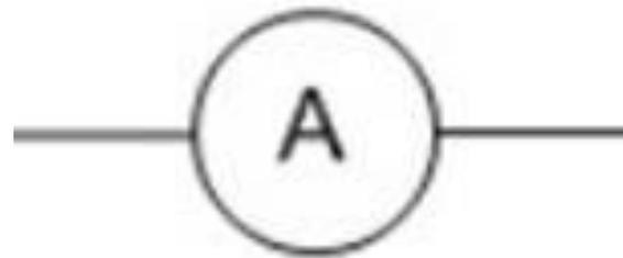
Обозначение амперметра на электрической схеме
