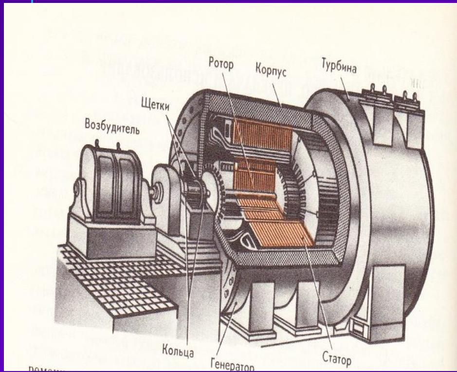
Генератор преобразует механическую энергию в электрическую. Действие генератора основано на явлении электромагнитной индукции.
