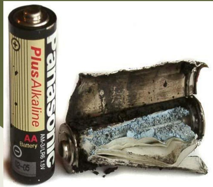
**Гальванический элемент** – химический источник тока, в котором электрическая энергия вырабатывается в результате прямого преобразования химической энергии окислительно-восстановительной реакцией.
