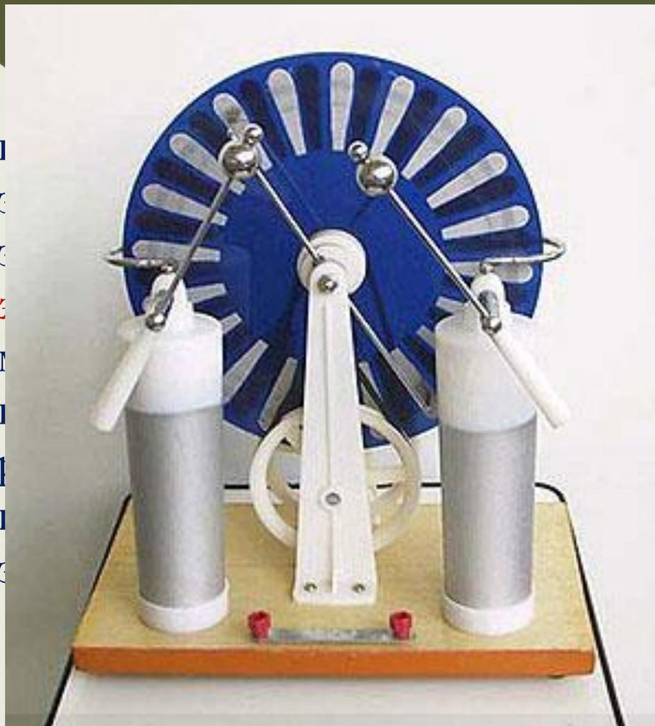
Механический источник тока - механическая энергия преобразуется в электрическую энергию.
