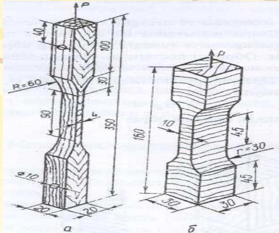
P – разрушающая нагрузка, Н;
