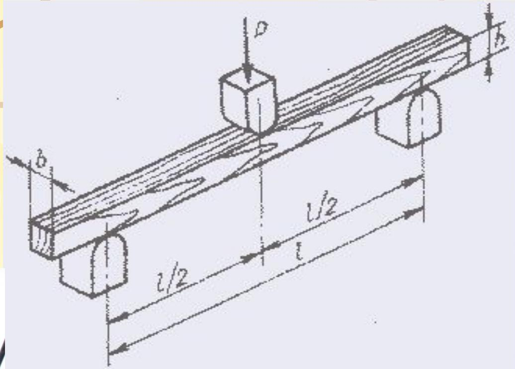
где  $l$  - пролет между опорами, м;  $a$  - расстояние между грузами, м;  $b$  и  $h$  - ширина и высота поперечного сечения балки, м.
