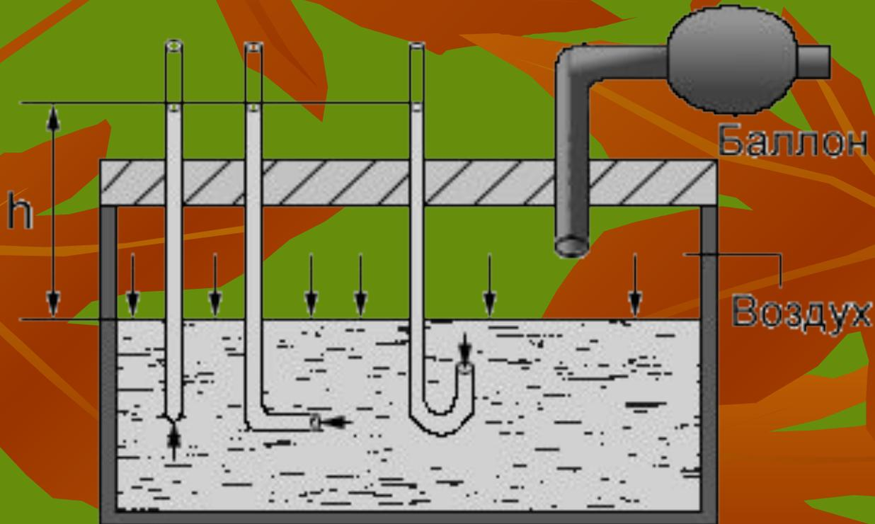
Формула  $p = \rho gh$  показывает, что давление, создаваемое слоем жидкости, не зависит от ее массы, а зависит от плотности жидкости, высоты ее слоя и места наблюдения. При увеличении толщины слоя жидкости или ее плотности гидростатическое давление будет возрастать.
