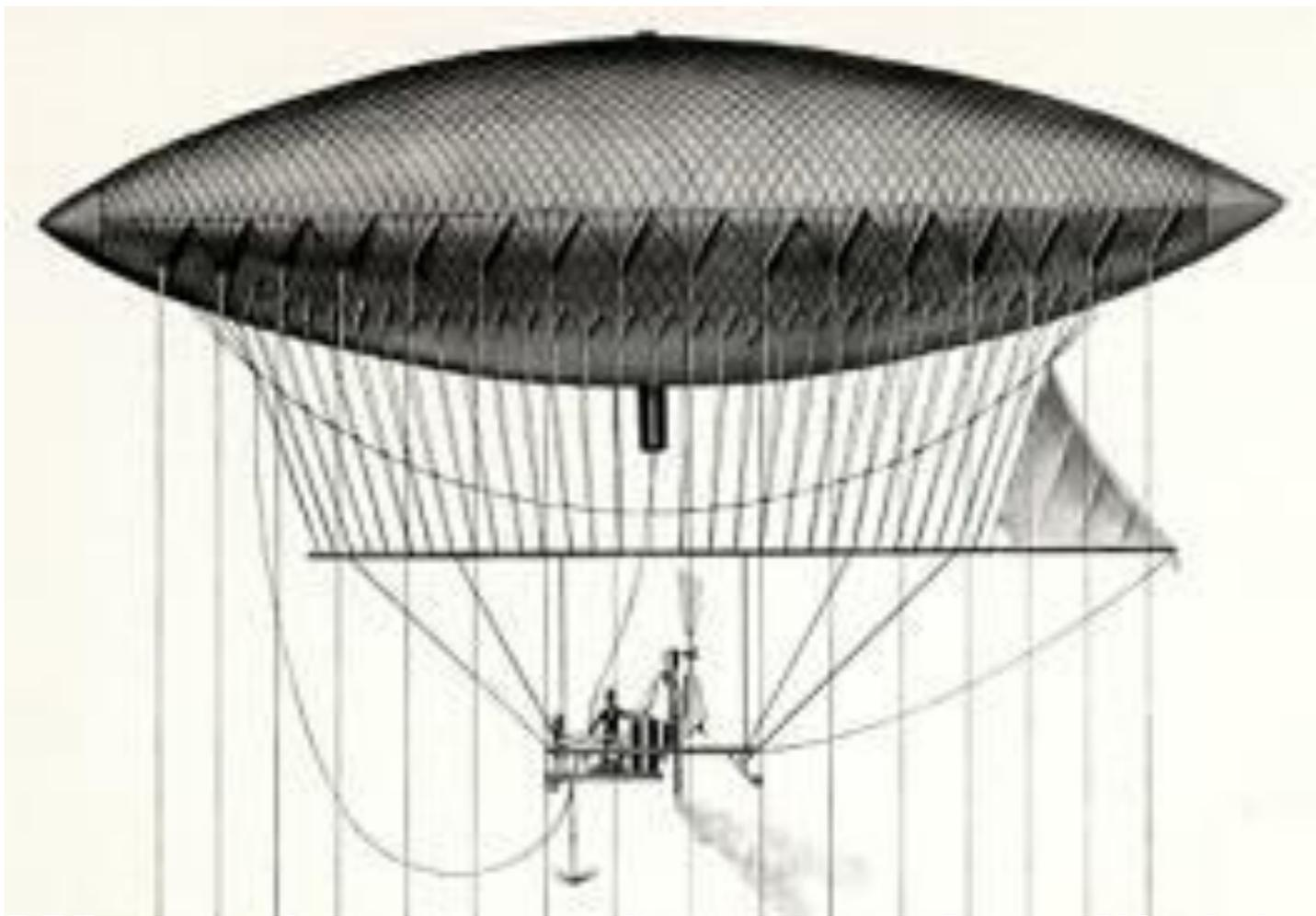
**В 1852 году французский механик Анри Жиффар смог превратить "стоящего в воздухе" в управляемого. Оболочка его аэростата была уже сигарообразной. Управлялся дирижабль с помощью парового двигателя мощностью 3 л.с. и весом 45 кг.**
