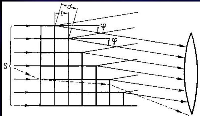
Ход лучей в прозрачном эшелоне Майкельсона. Исходный пучок света  $S$  направляют на эшелон под углом, очень мало отличающимся от прямого. Поэтому крайне мал и угол дифракции  $\phi$  лучей, прошедших через эшелон (пунктиром показан ход луча при наклонном падении).  $d$  — разность хода лучей от соседних ступенек, близкая к высоте ступеньки  $t$ .
