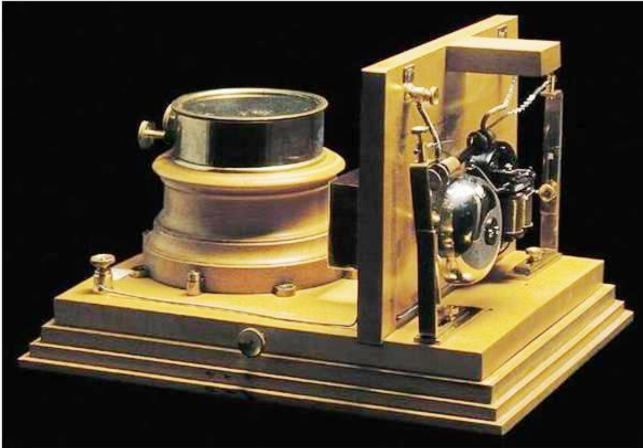
Первый радиоприёмник, изобретённый А.С. Поповым в 1895 году.
