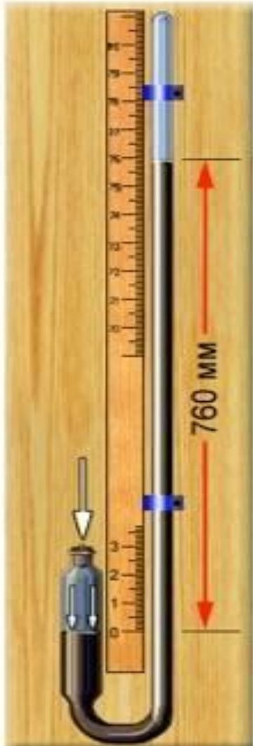
СХЕМАТИЧЕСКОЕ УСТРОЙСТВО РТУТНОГО БАРОМЕТРА
