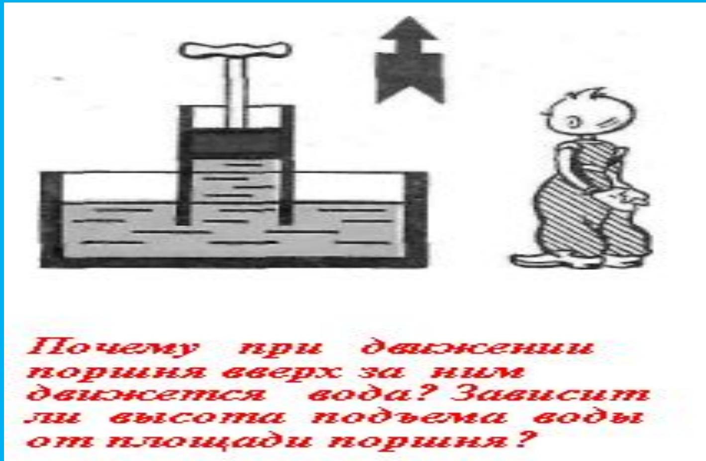
*Почему при движении поршня сверх за ним движется вода? Зависит ли высота подъема воды от площади поршня?*
