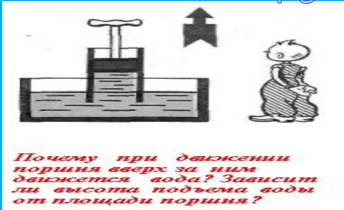
*Почему при движении поршня вверх за ним движется вода? Зависит ли высота подъема воды от площади поршня?*
