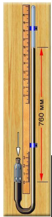
СХЕМАТИЧЕСКОЕ УСТРОЙСТВО РТУТНОГО БАРОМЕТРА
