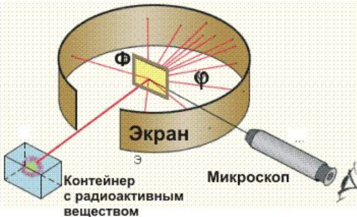
Схема опыта Резерфорда по рассеянию \alpha - частиц.
