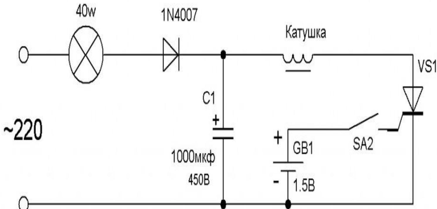
**Емкость конденсатора = 1000 мкФ, напряжение 450 В, лампа 40 ватт, катушка, 2 полупроводника 1N4007, VS1, источник питания-1,5 В. Используя данную схему была собрана пушка Гаусса**
