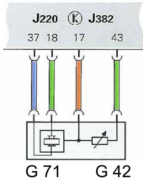
– Оба датчика изготовлены в одном корпусе
