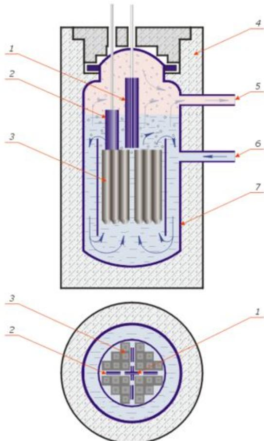
**Схема кипящего корпусного ядерного реактора:**
