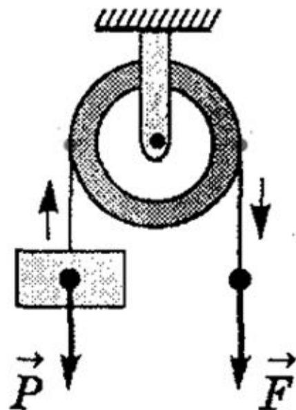
Это блок, ось которого закреплена и не поднимается, и не опускается вместе с грузом
