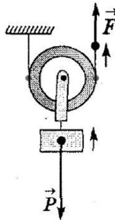
Это блок, ось которого поднимается и опускается вместе с грузом
