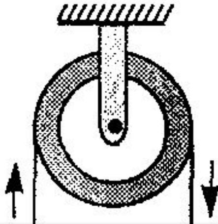
Неподвижный блок применяют для того, чтобы изменить направление действия силы.
