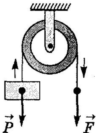
Блок – колесо с желобом, укрепленное в обойме. По желобу пропускают веревку, трос или цепь.
