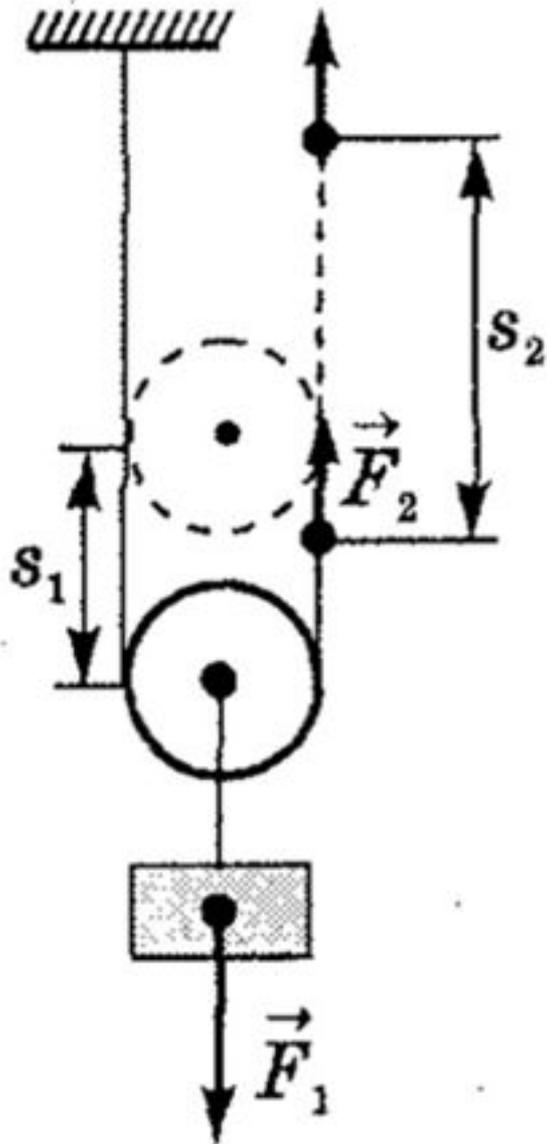
Используя подвижный блок, мы в два раза выиграли в силе, но в два раза проиграли в расстоянии.
