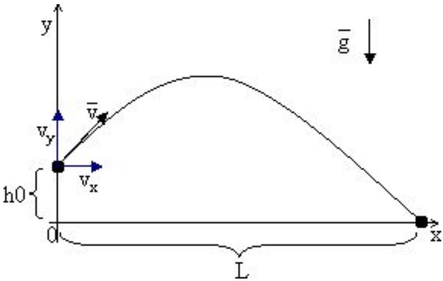
$$x = v_0 t \cos \alpha \qquad y = y_0 + v_0 t \sin \alpha - \frac{gt^2}{2}$$
