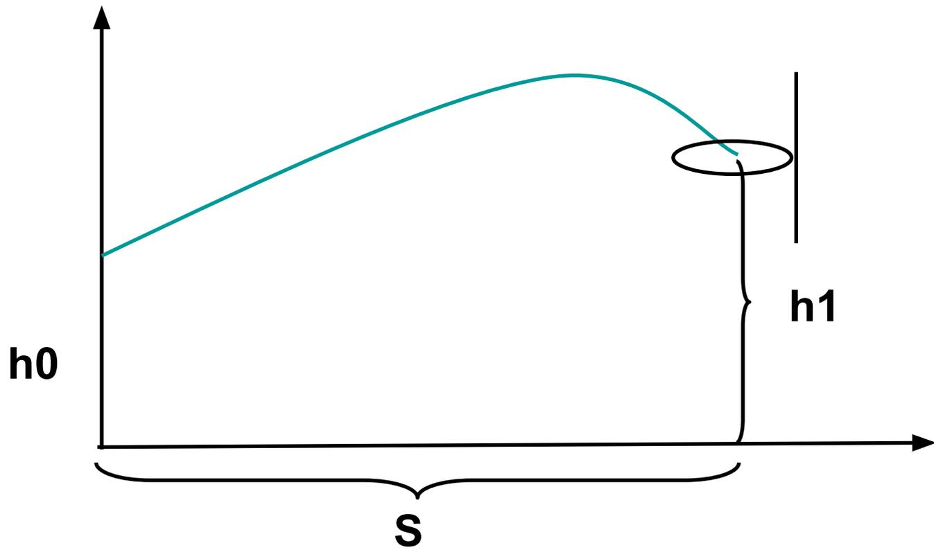
$$x = v_0 t \cos \alpha \qquad y = y_0 + v_0 t \sin \alpha - \frac{gt^2}{2}$$
