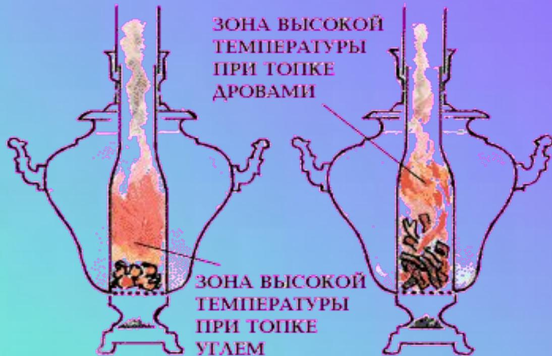
Лучшее топливо для самовара - древесный уголь. Количество сгоревшего углерода, а следовательно, и выделившегося тепла пропорционально расходу кислорода. Это дает возможность регулировать процесс топки подачей воздуха. Горение не должно быть чересчур интенсивным, иначе возрастают теплопотери
