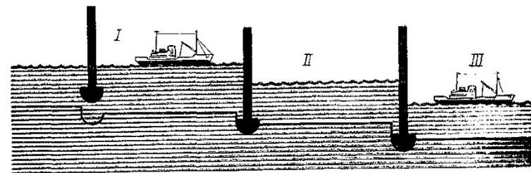
80 Во всех сообщающихся сосудах давление жидкости одинаково. Поэтому независимо от формы сосуда жидкости одинаковой плотности устанавливаются на одном уровне. Высота более плотной жидкости меньше высоты жидкости с меньшей плотностью.
