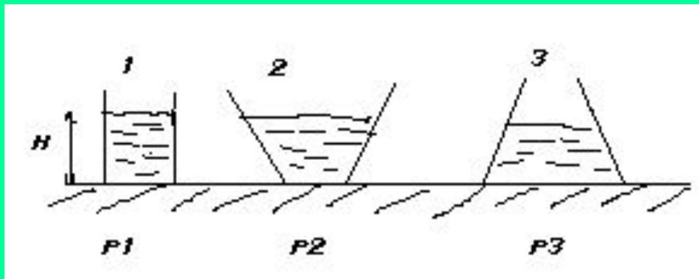
Определите давление нефти на дно цистерны, если высота столба нефти 10 м, а плотность ее  $800 \text{ кг/м}^3$
