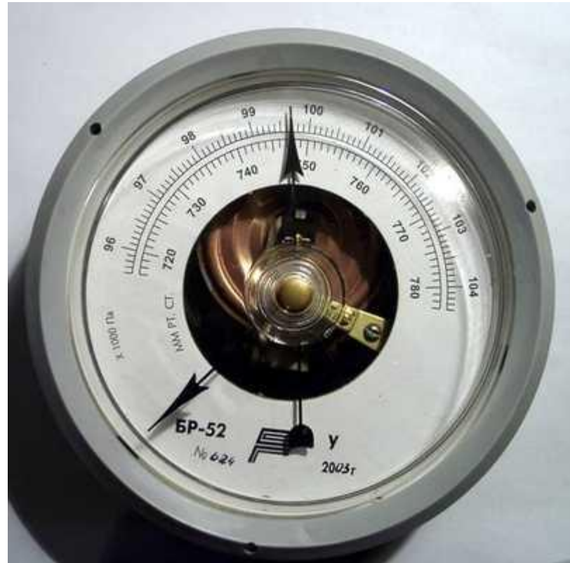
Рис. 4.2.4. Внешний вид барометра-анероида.
