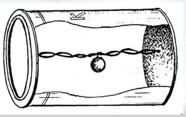
Когда банка вращается, грузик висит вертикально и резина закручивается, кинетическая энергия банки переходит в потенциальную энергию закручивания резины и банка останавливается, после чего резина начинает раскручиваться и приводит в движение банку.
