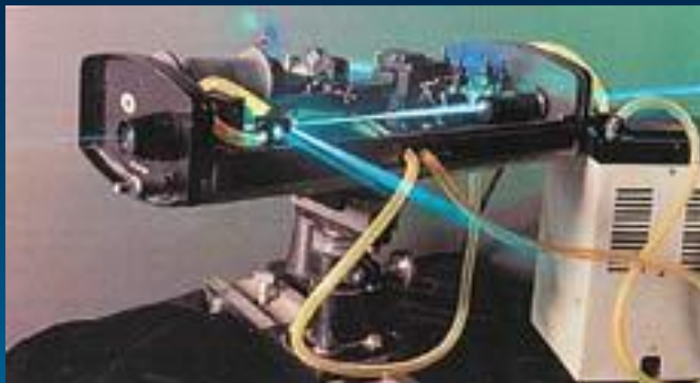
Жидкостный лазер на красителях.
