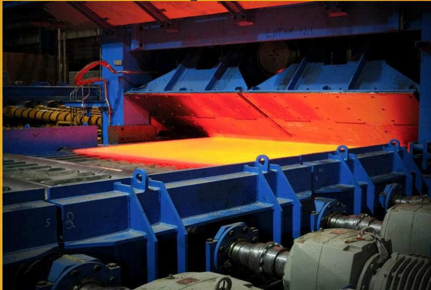
Действие силы трения можно наблюдать в листопрокатных цехах. Прокатка — завершающая часть полного металлургического производства. Прокатка осуществляется на прокатных станах. Прокатываемый сляб увлекается силой трения, возникающей между валками и слябом.
