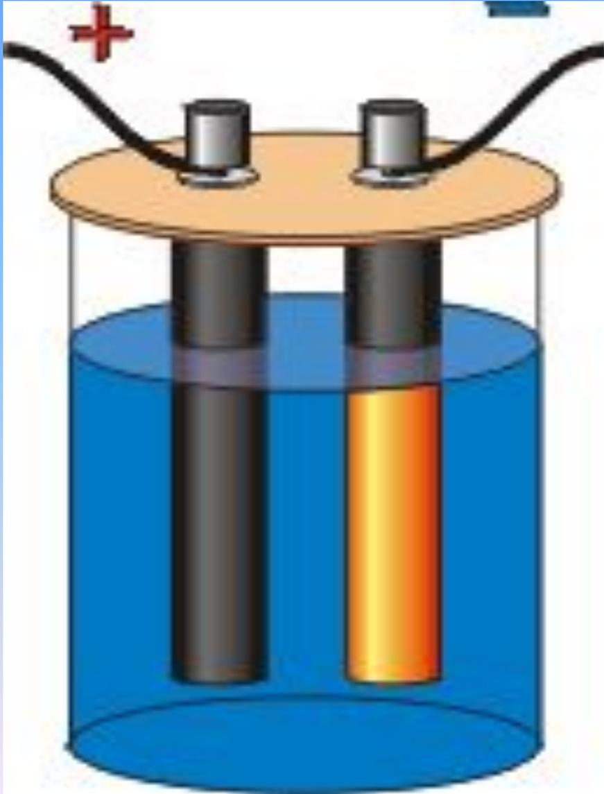
**ГАЛЬВАНОПЛАСТИКА** - это электрохимический процесс, в результате которого на поверхности какого-либо предмета, форму которого хотят воспроизвести, осаждается толстый слой металла.
