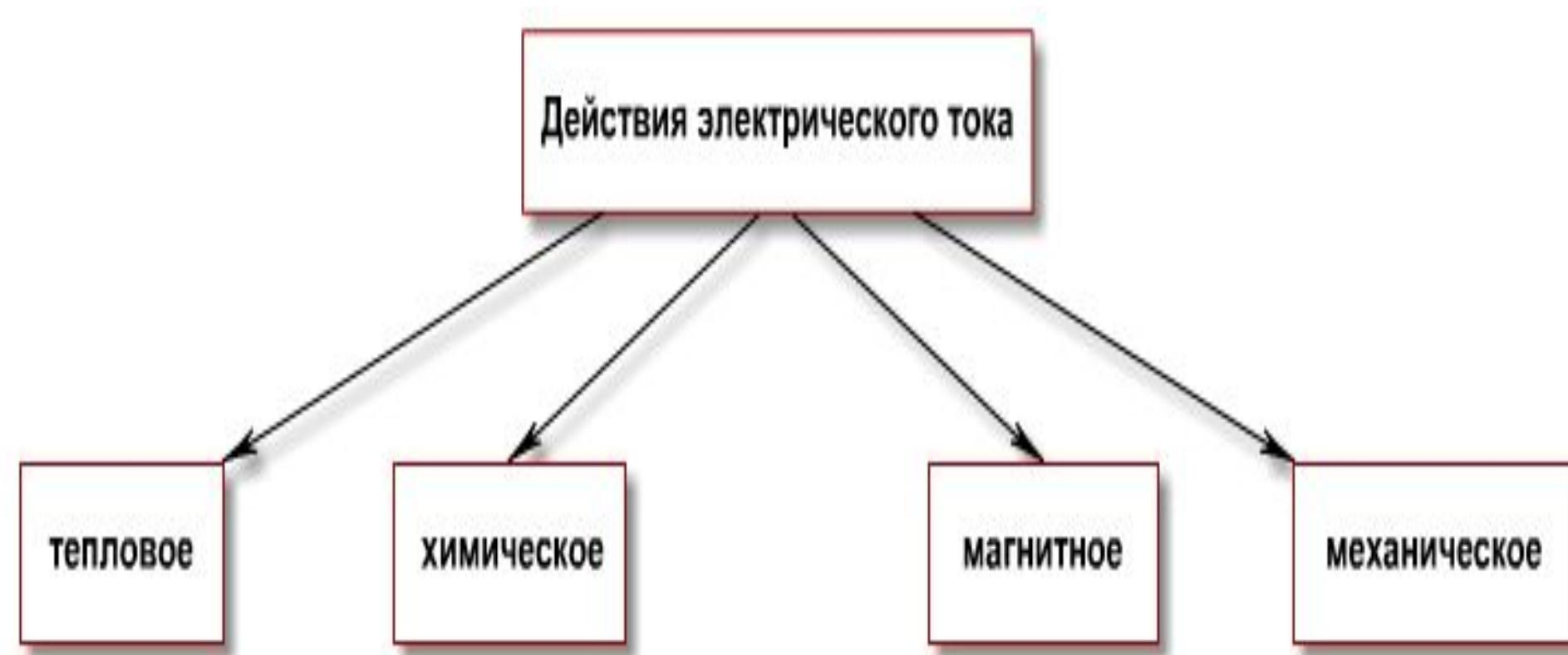
**Тепловое действие тока** заключается в нагревании проводников при протекании по ним электрического тока.
