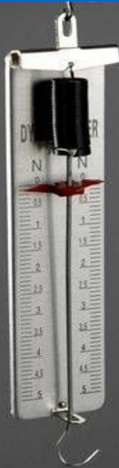
Для измерения силы используют – прибор **динамометр** (греч. "динамис" – сила).
