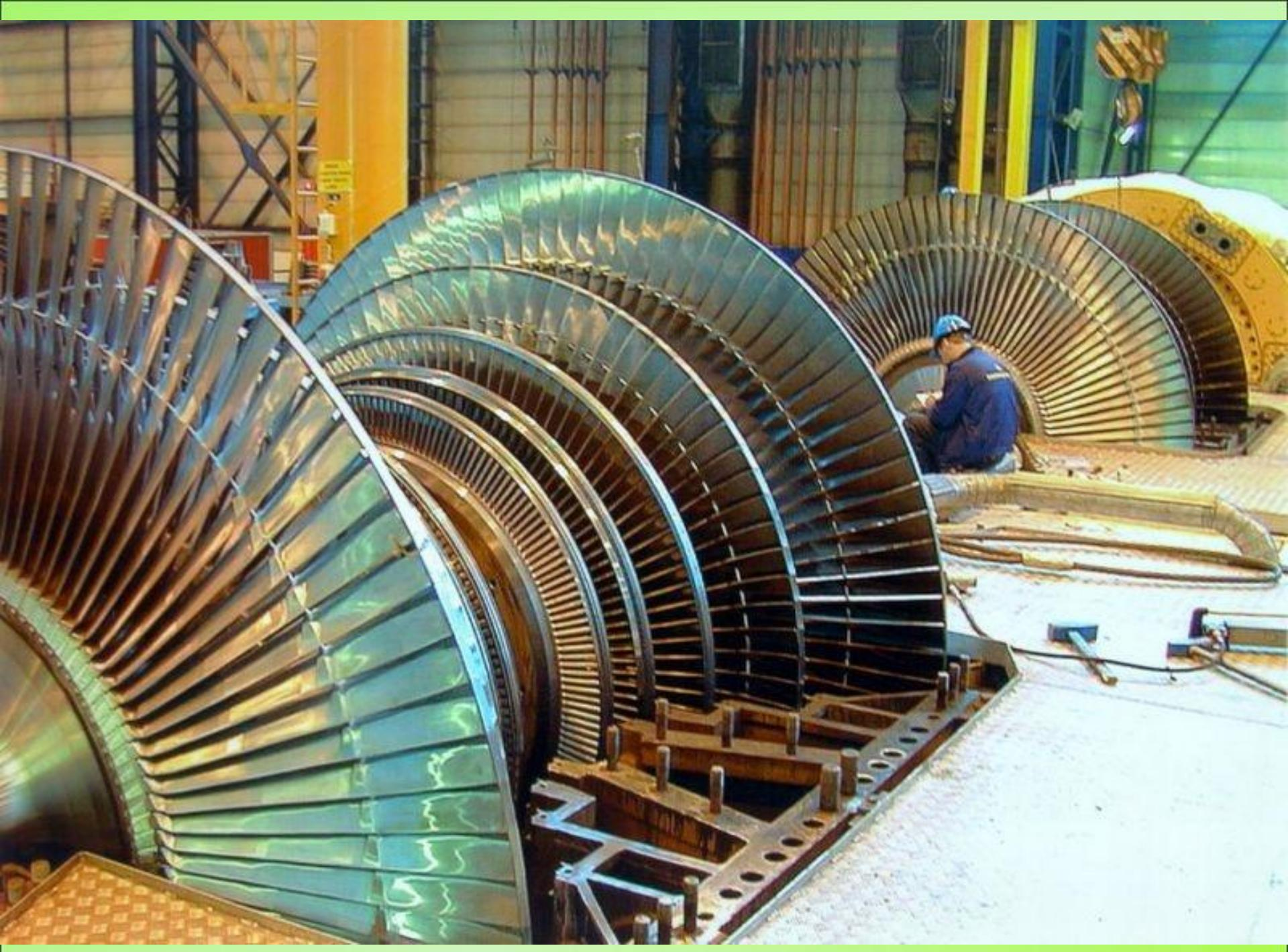
Газовая турбина – это тепловой двигатель, в котором энергия сжатого и нагретого газа преобразуется в механическую работу
