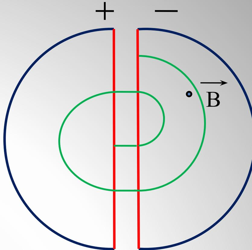
Циклотрон – циклический ускоритель
