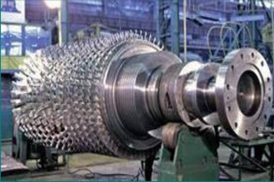
Ротор газовой турбины
