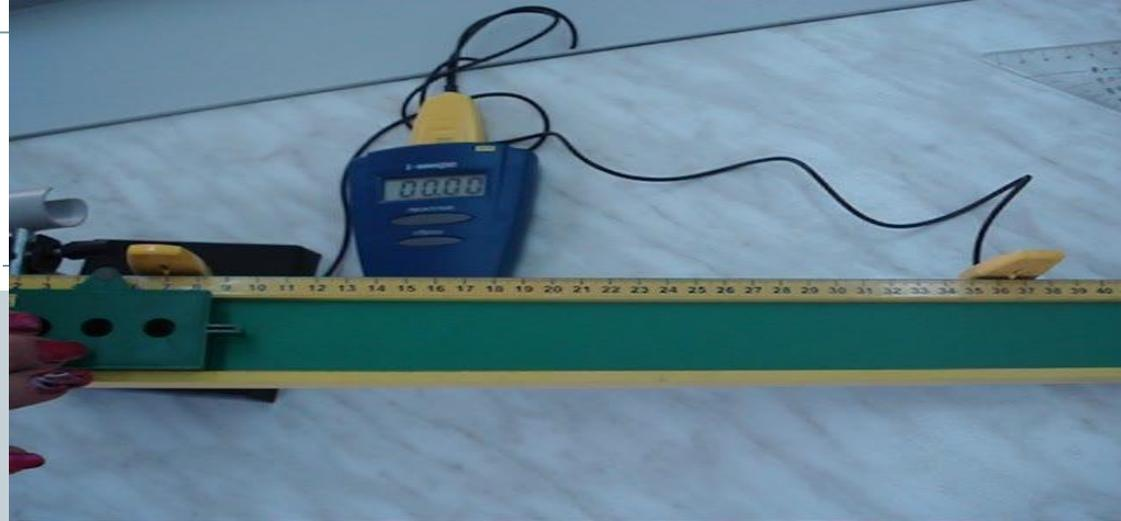
На рисунке представлена фотография установки для исследования скольжения бруска по наклонной плоскости. В центр бруска вставлен магнит. Числа на линейке обозначают сантиметры. В момент начала движения магнит, находящийся в бруске, через верхний датчик включает секундомер при прохождении магнита мимо нижнего датчика секундомер выключается. Масса бруска 50 г, угол наклона плоскости  $\alpha = 30^\circ$ . Определите работу силы трения на участке между датчиками?
