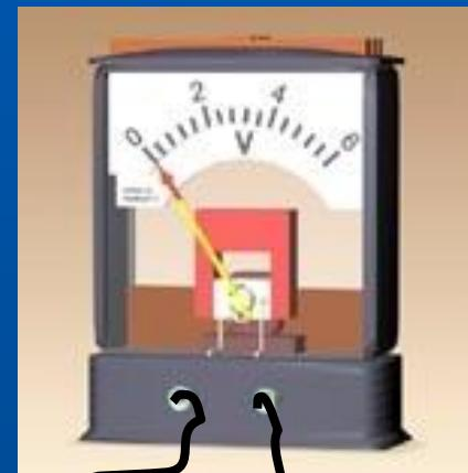
Измерим напряжение на различных участках цепи, состоящей из реостата и лампочки. Сначала измерим напряжение на реостате: ... Затем измерим напряжение на лампочке: ... И, наконец, напряжение на всем соединении ...
