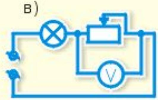
Измерения показывают, что в цепи с последовательным соединением проводников напряжение на всем соединении равно сумме напряжений на отдельных проводниках:
