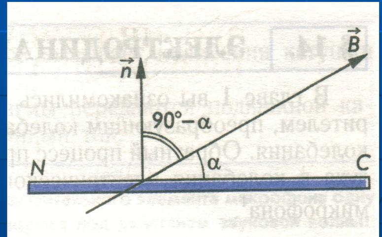
**Найти ЭДС индукции в проводнике с длиной активной части 25 см, перемещающемся в однородном магнитном поле индукцией 8 мТл со скоростью 5 м/с под углом  $30^\circ$  к вектору магнитной индукции**
