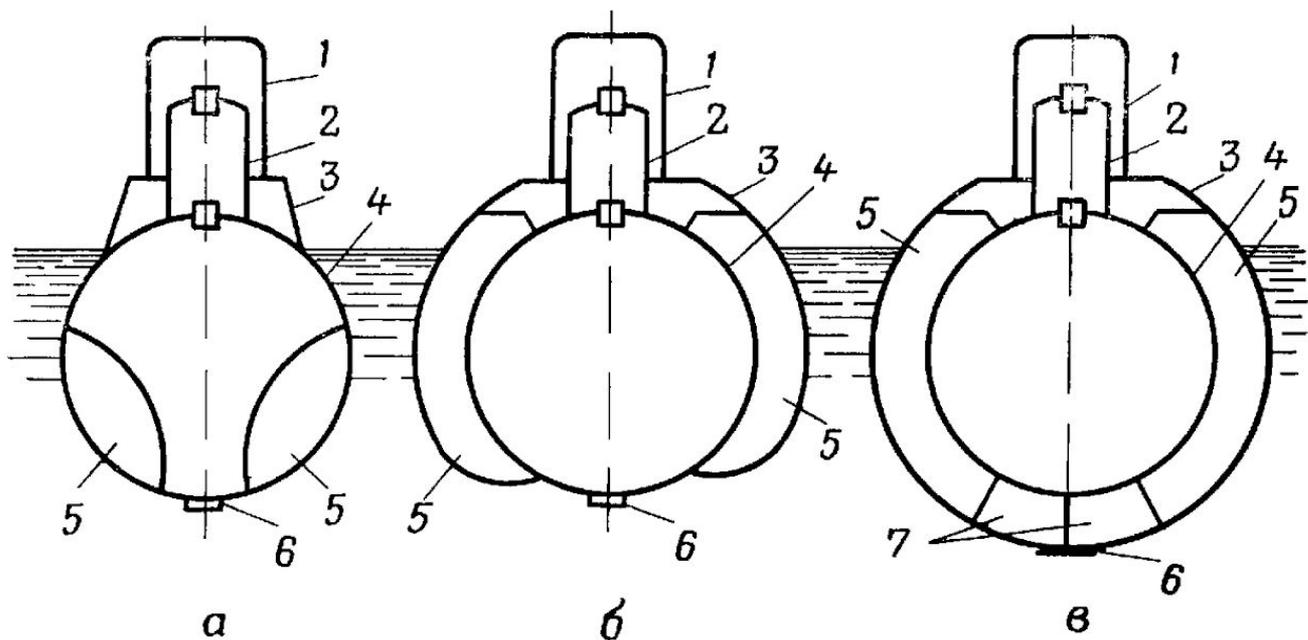
*а – однокорпусная лодка, б – полторакорпусная, в – двухкорпусная*
