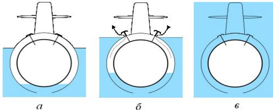
Цель исследования: разработка конструкторского решения корпуса подводной лодки, исключающего присасывание корпуса при частичном погружении лодки в грунт дна моря
