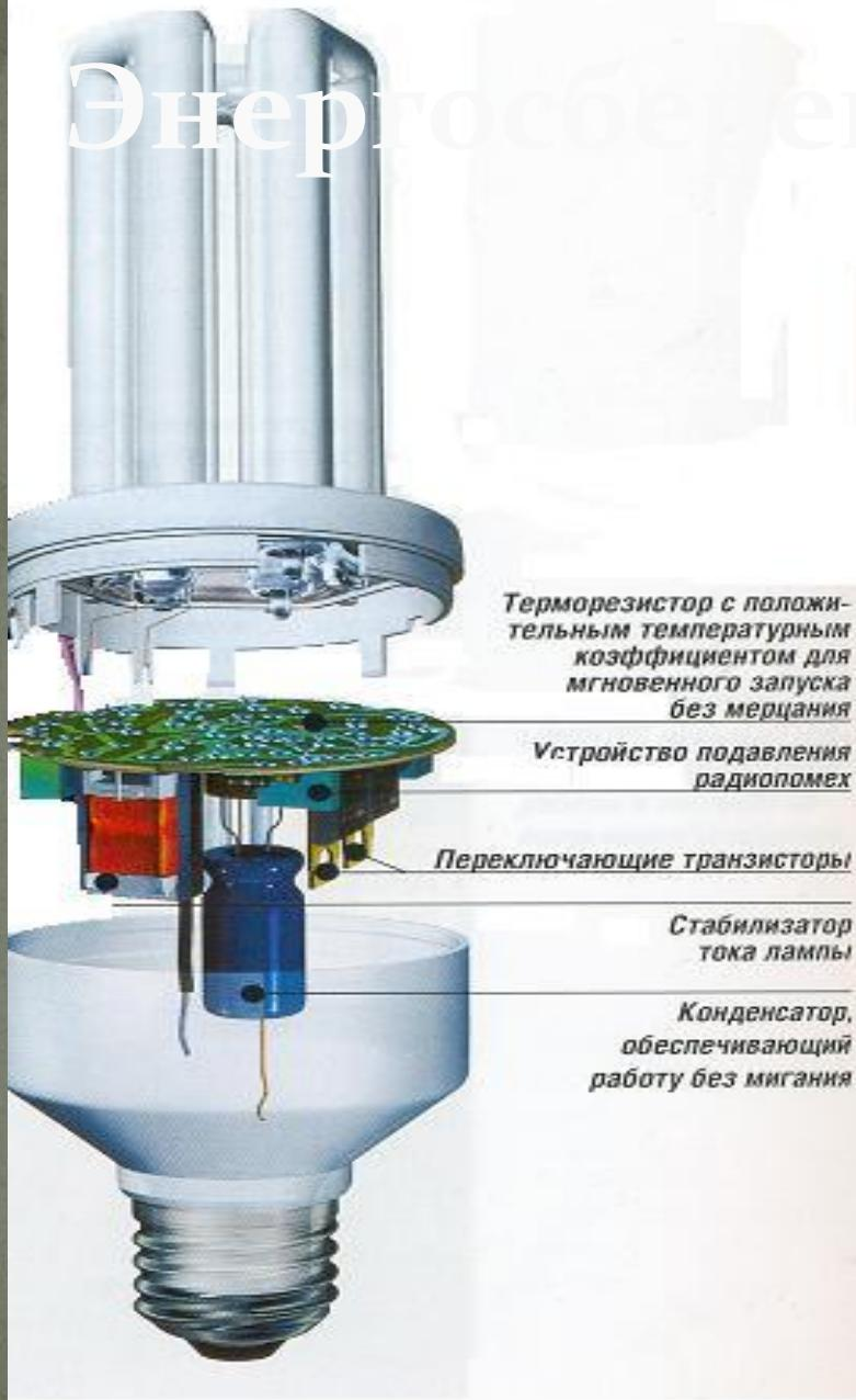
Это «трубка дневного света»: трубка, свернутая в спираль или змейку, и наполненная парами ртути. На стенки трубы нанесен люминофор. Пары ртути под действием электрического разряда начинают излучать ультрафиолетовые лучи, а те в свою очередь заставляют нанесенный на стенки трубы люминофор излучать свет. В цоколь лампы помещается ЭПРА, которая обеспечивает старт такой лампы.
