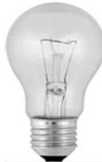
Если напряжение на обычновенной лампе меньше номинального, то выделяющаяся мощность уменьшится, и свечение лампы станет менее ярким. При увеличении напряжения на 1%, лампа светит ярче, но **срок ее службы уменьшается на 15%.** Если напряжение превысит номинальное на 15% - то лампа выйдет из строя. Энергосберегающие лампы при включении загораются постепенно – не наносят ощутимого давления на проводку.
