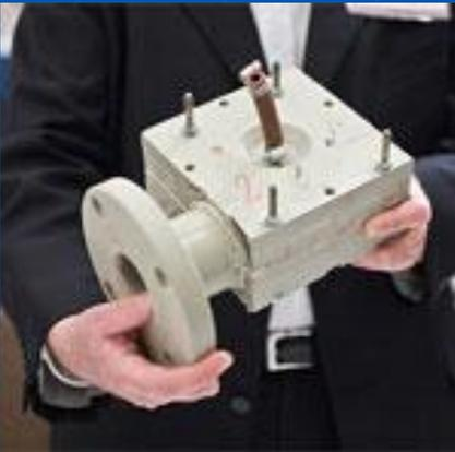
В качестве объекта для испытаний сотрудники компании Leviathan Energy использовали обычный унитаз. По задумке разработчиков система должна генерировать небольшое количество энергии при каждом спуске воды с помощью специального устройства, которое получило название Benkatine Turbine. Устройство позволяет вырабатывать энергию из любой трубы, по которой течет вода. Причем, для использования подходят как чистые, так и канализационные воды.
