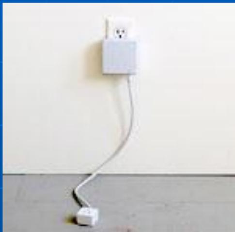
Устройство под названием Leech Plug, что в переводе на русский язык означает «штепсель-пиявка». Это устройство позволит подключать телефон к зарядному устройству и, не переживая за энергопотери, оставлять его там хоть на всю ночь. Leech Plug фиксирует полную зарядку подключенного к нему устройства и самостоятельно отключается от розетки. Реализована «пиявка» при помощи таймера и электромеханической схемы, которая физически отключает штепсель от розетки.
