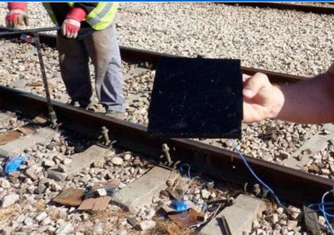
Прибор для получения электричества с использованием энергии проходящих поездов получил название **IPEG PAD**. Разработка представляет собой колодку со встроенным пьезоэлектрическим генератором. Колодка устанавливается на рельсы и подключается к местной электросети.
