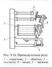
напряжение, в магнитопроводе появляется магнитный поток, который способствует перемещению якоря 4. Движению якоря препятствует пружина 5, создающая удерживающую силу. Якорь связан механически с подвижными контактами.
