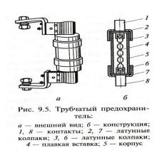
Плавкие вставки изготавливаются из сплавов, содержащих свинец, олово, медь и другие элементы. Действие предохранителя основывается на том, что они включаются последовательно в электрическую цепь и если ток в цепи превышает ток вставки, то легкоплавкая вставка перегорает и цепь отключается.
