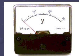
Вольтметр переменного тока
