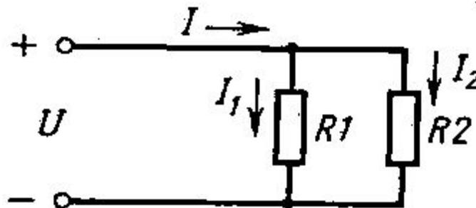
3. Найдите отношение напряжений  $U_1/U_2$  (рис. 3), если  $R_1 = 5 \text{ Ом}$ ,  $R_2 = 15 \text{ Ом}$
