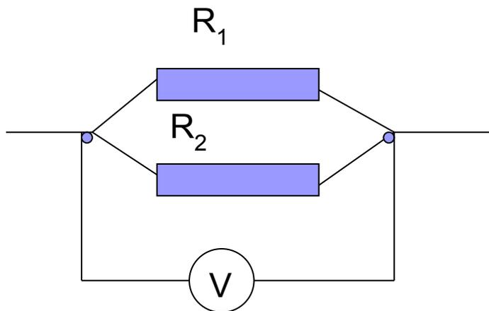
При параллельном соединении элементов цепи напряжение на всех участках
