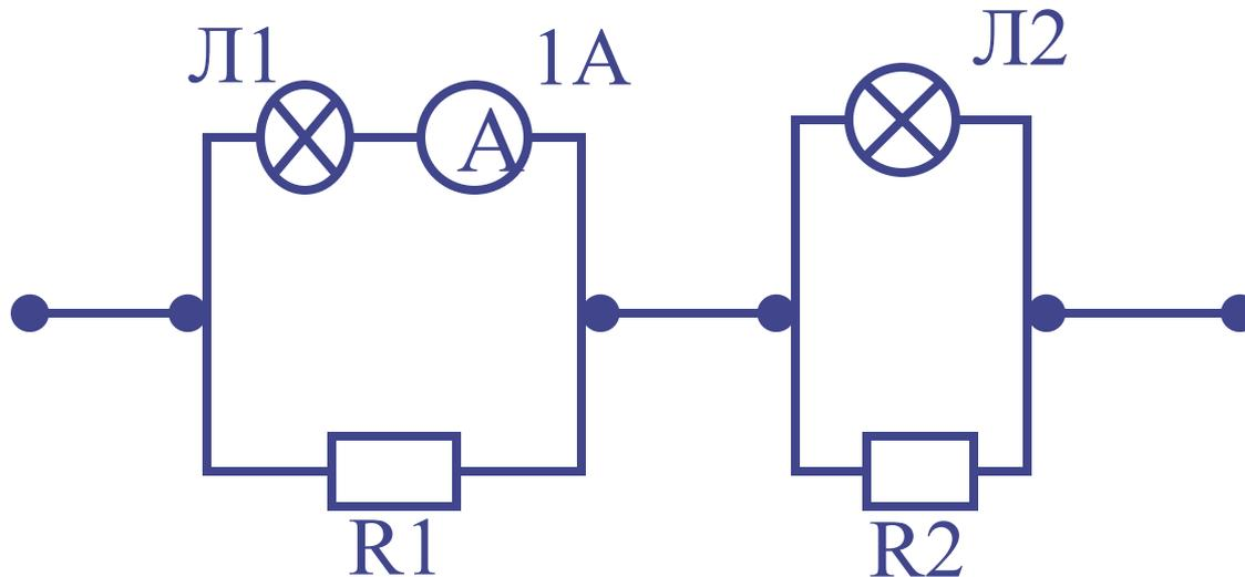
Определите мощность, потребляемую лампой Л2, если сопротивления ламп Л1 и Л2 соответственно равны 6 Ом и 5 Ом, а сопротивления резисторов равны  $R_1=3$  Ом,  $R_2=20$  Ом.
