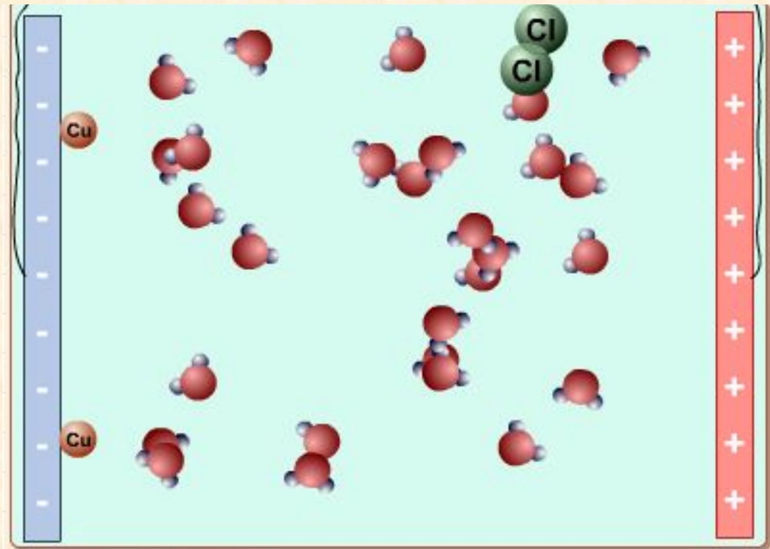
Ток в растворах электролитов – это упорядоченное движение положительных и отрицательных ионов.
